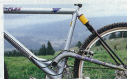
La suspension arrière du Proflex 953 est commune à tous les modèles haut de gamme de la marque.
