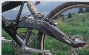
Bras oscillant en aluminium et combiné amortisseur oléo-pneumatique Fox, le Super V dispose d'une suspension arrière élaborée.
